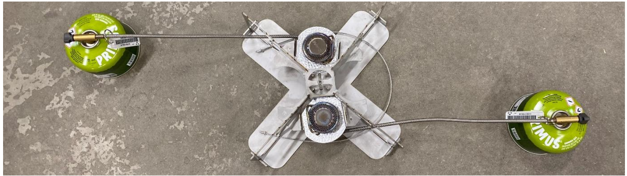
Brännarstativet med Gasbrännare Storm monterade. Bränsle, Primus sommargas.
