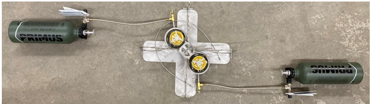
Brännarstativet med Omnifuel brännare monterade. Bränsle, Aspen bensin.
