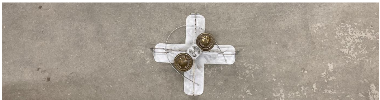
Brännarstativet med Spritbrännare B25 monterade. Bränsle, rödsprit.
