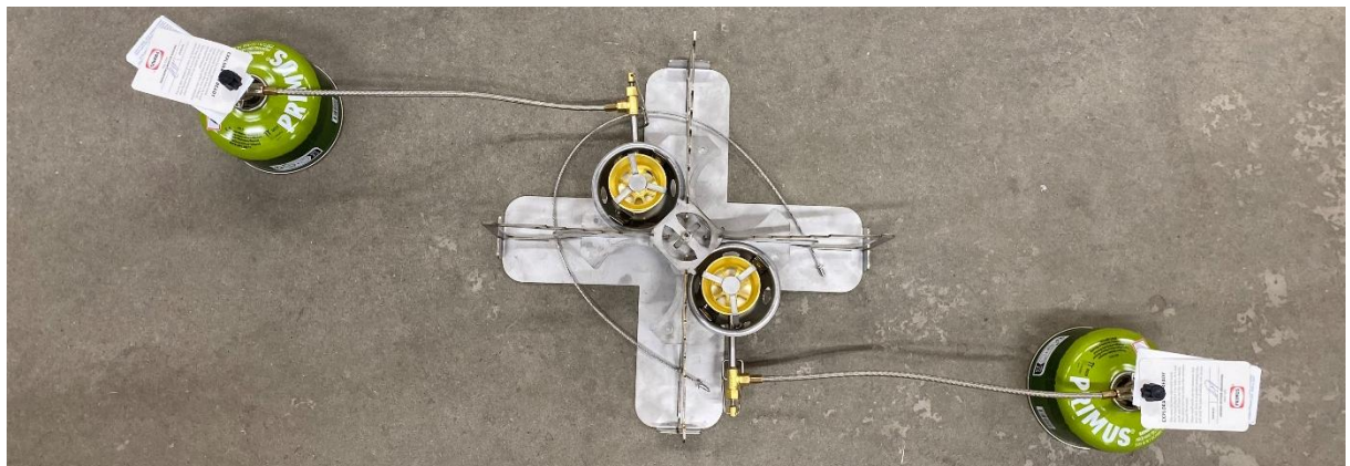
Brännarstativet med Omnifuel brännare monterade. Bränsle, Primus sommargas.
